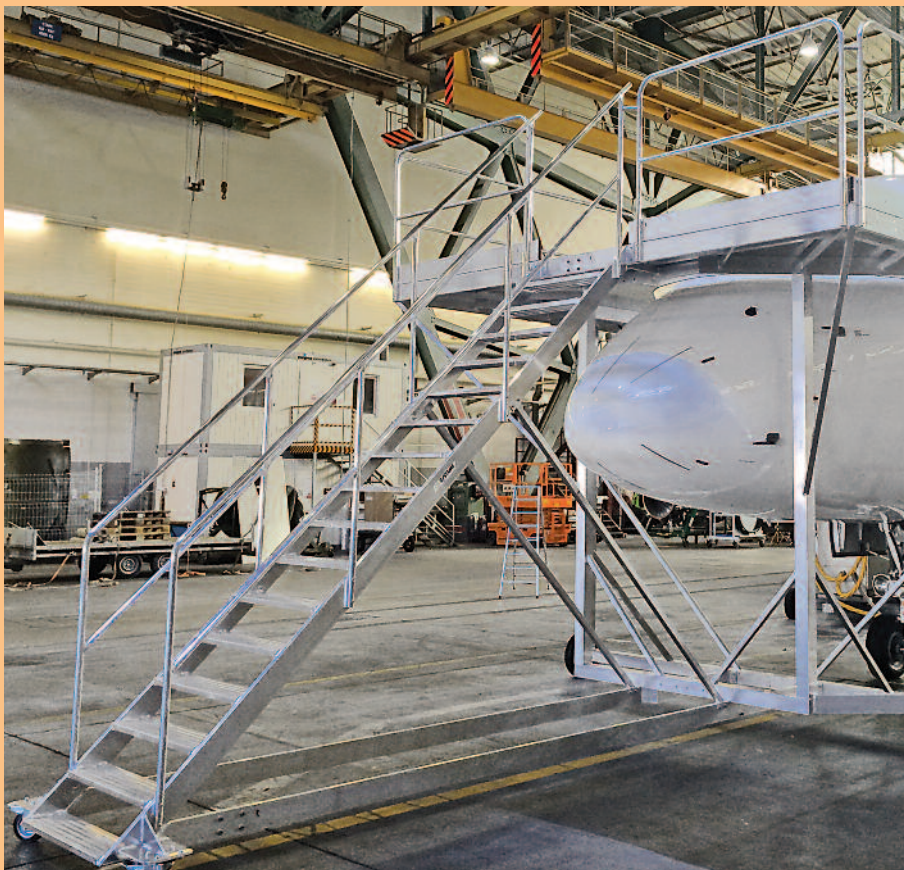
Plateforme roulant pour l'entretien des avions
