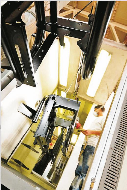
Tuyaux courbés et profils convenablement façonnés évitent le dépôt des poudres d'engrais, et favorisent les lavages sur toutes les parties du châssis et de la trémie.
