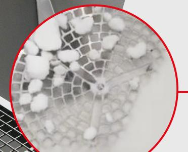
Le système de trémie à fond oscillant qui alimente de façon continue et constante le système de distribution. La non-utilisation des agitateurs empêche le broyage du produit, permettant au même temps un **dosage toujours homogène de la quantité choisie**, d'engrais granulés, pulvérulents, amendements organiques et semences.
