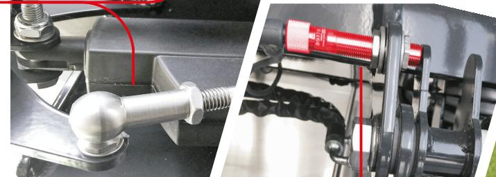
**Deux détecteurs de position** détectent l'état ON/OFF du système hydraulique et donc la distribution. Afin d'éviter d'épandre au-delà de la limite de champ, le **GPS** transmet le signal de départ de la distribution après que le tracteur ait dépassé le début du champ égal à la largeur d'étalement de l'épandeur d'engrais.
