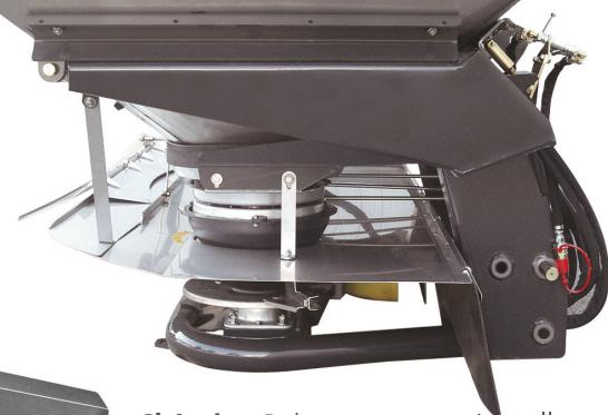
**Châssis :** Robustesse exceptionnelle avec **charges utiles jusqu'à 3600 kg**. Attelage de II et III catégorie et versatilité d'attelage avec trois différentes positions ; normale, avancée de 100 mm, relevée de 150mm pour **apports tardifs**.
