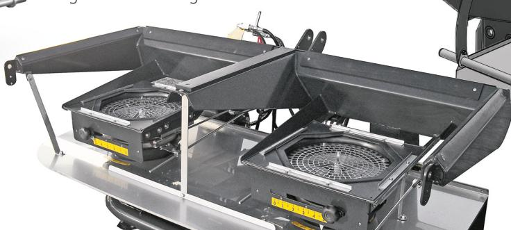
**Renfort intérieur : monté de série sur toutes les modèles double disque**, ce support central de renfort contient quatre fiables attelages pour le soulèvement de la machine et est préparé pour le fixage des **grilles de filtrage rabattables** (sur requête).
