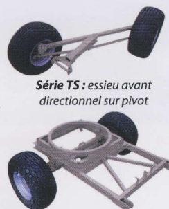
Série GT et GR : essieu avant monté sur tourelle à bille
