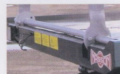
Sur plateaux 12,00 m : montage encastré coulissant, déport jusqu'à 0,45 m
