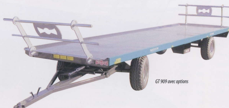
Série GT et GR : essieu avant monté sur tourelle à bille
