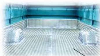
Plancher monocoque aluminium « TOP GRIP »
