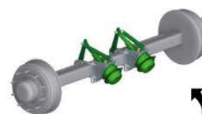
Freinage mixte : combine le freinage pneumatique et hydraulique.
